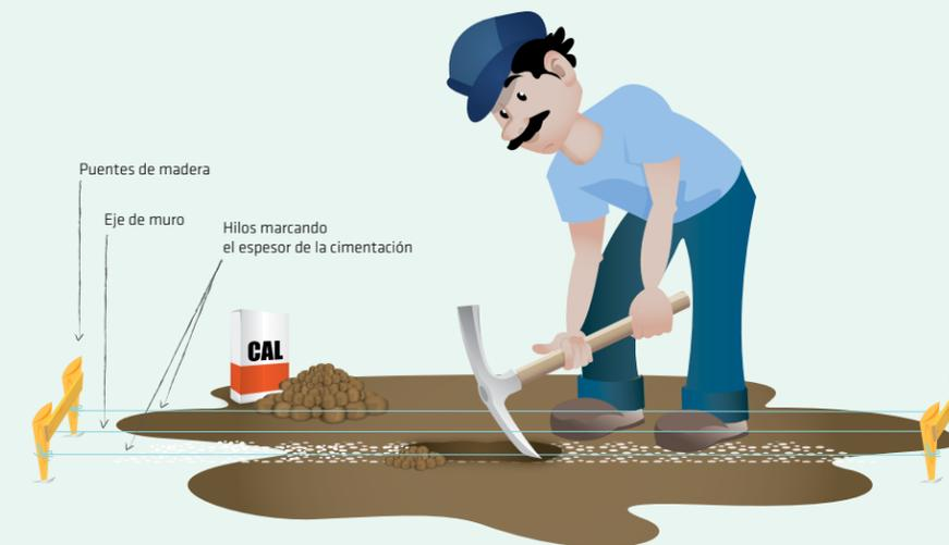
*Las piedras deberán ser duras y resistentes, evitando aquellas porosas y quebradizas que pudieran comprometer la resistencia de la cimentación.*
